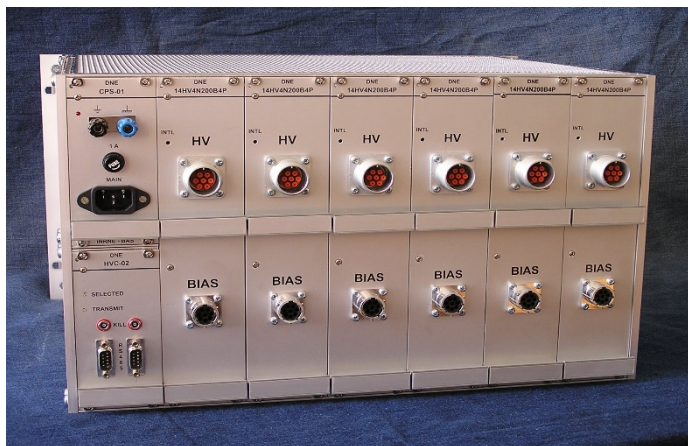
Фиг. 10. Един кейт с 6 модула от високоволтовата система за адронния калориметър
