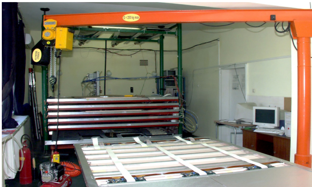
Фиг. 15. Изпитване на 5 RPC-камери с космични мюони на създадения за целта стенд
