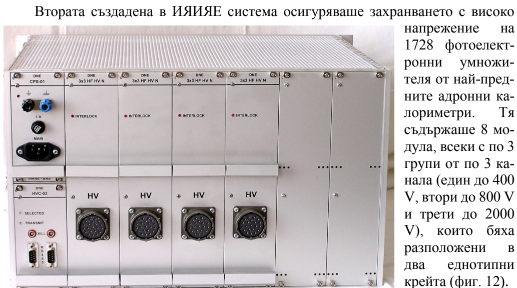
Фиг. 12. Един крейт с четири модула от захранващата система на най-предния адронен калориметър
