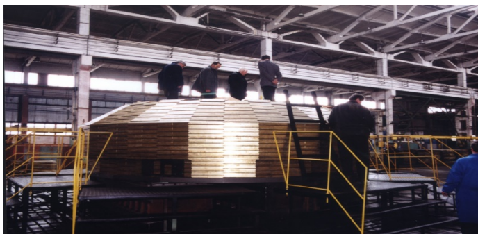
Фиг. 8. Месингови плочи за адронния калориметър изработени в КЦМ, България части на адронния калориметър в детектора CMS бяха произведени в Комбината за цветни метали (КЦМ), гара Искър, София (фиг. 8).
